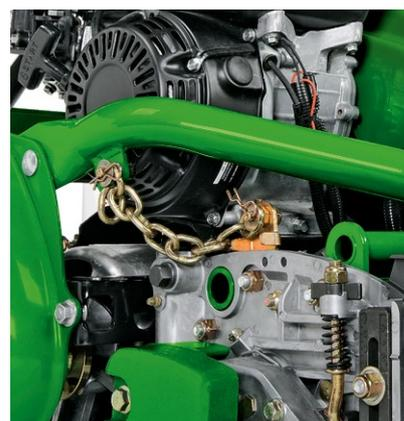
**Profili regolabili:** le catene di limite sulla macchina da green 180 E-Cut™ possono essere regolate su un'ampia gamma di movimenti per adattarsi ai contorni ed alle pendenze di qualsiasi green.
