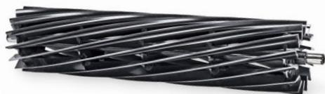
**Unità di taglio a 14 lame:** La frequenza di battuta è determinata da una combinazione di velocità dei cilindri, velocità di taglio e numero delle lame sul cilindro. È possibile scegliere tra unità di taglio a 7, 11 e 14 lame, in base alle proprie esigenze.
