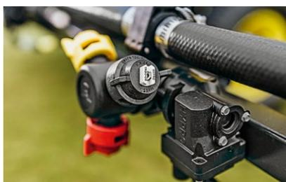
**Accuratezza infallibile:** ogni ugello in ogni sezione viene controllato automaticamente e spruzza solo all'interno di un'area mappata che non è stata ancora trattata.
