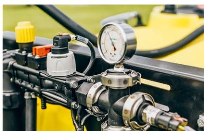
**Volumi precisi:** L'impianto idraulico semplificato, il flussometro e la pompa di regolazione del numero di giri consentono volumi di spruzzatura precisi.
