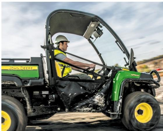
**La sicurezza prima di tutto:** ogni veicolo è dotato di tettuccio con struttura di protezione (ROPS) e di comode cinture di sicurezza a tre punti per garantire la vostra sicurezza in ogni momento.
