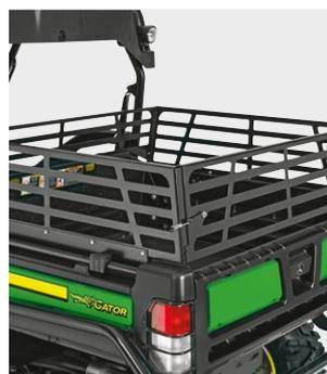
**Prolunga laterale cassone:** aumentate l'altezza laterale e il volume del cassone per raddoppiare la capacità di trasporto. La parte alta della sponda posteriore si inclina per semplificare l'accesso.
