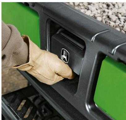
**Sponda posteriore:** la sponda posteriore tipo pick-up si apre all'esterno fino a 90 gradi e verso il basso di 150 gradi con una sola mano.
